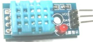
Gambar 3. Sensor DHT11
