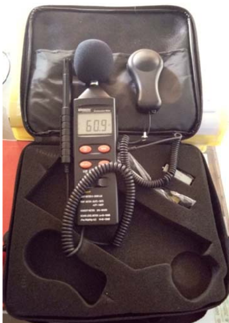
Gambar 1. Alat Ukur Krisbow Sound Level Meter Lingkungan Kerja Kebisingan, Suhu, Pencahayaan. Sumber: Dokumen Peneliti
